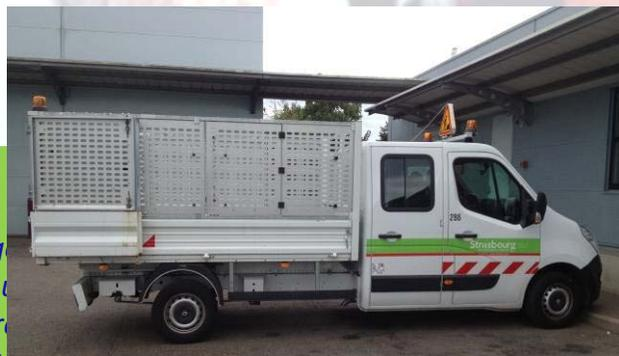
Véhicule équipé Châssis double cabine 3,5 T
