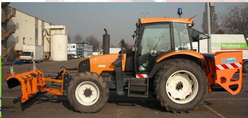
Tracteur équipé de la saleuse ACOMETYS 800L autochargeuse et lame 2,2 m
