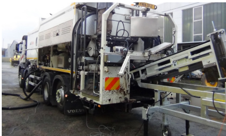
Figure n°4 : Vue de la sauterelle réceptrice des granulats en position à la place du malaxeur
