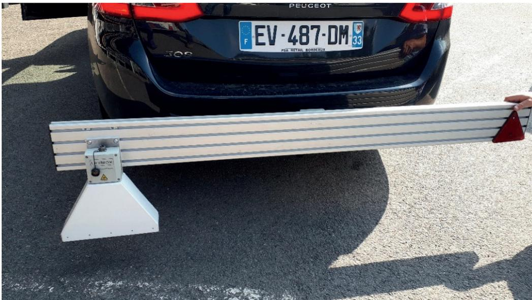
Figure n°4 : Exemple de dispositif de fixation de l'UniBox et de son dispositif assurant l'ombre
