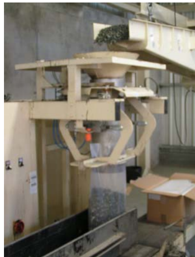
La première tonne s'écoulant de la trémie à été mise au rebut pour chaque fraction et la mise en sac des échantillons a été réalisée à l'aide de l'installation d'ensachage
