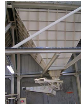
Sur chaque stock, environ six tonnes de matériaux ont été prélevés à la chargeuse par fraction et déversés dans la trémie de l'usine d'ensachage
