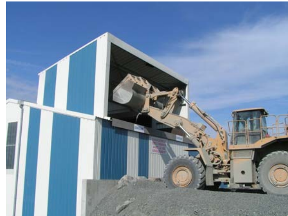
Sur chaque stock, environ six tonnes de matériaux ont été prélevés à la chargeuse par fraction et déversés dans la trémie de l'usine d'ensachage
