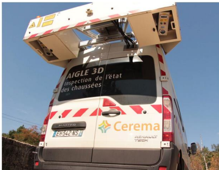
Aigle 3D : auscultation de l'état des chaussées à grand rendement. Cerema
