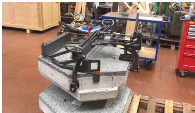
Fig. Chaussées Urbaines Démontables à surfaces fonctionnalisées
