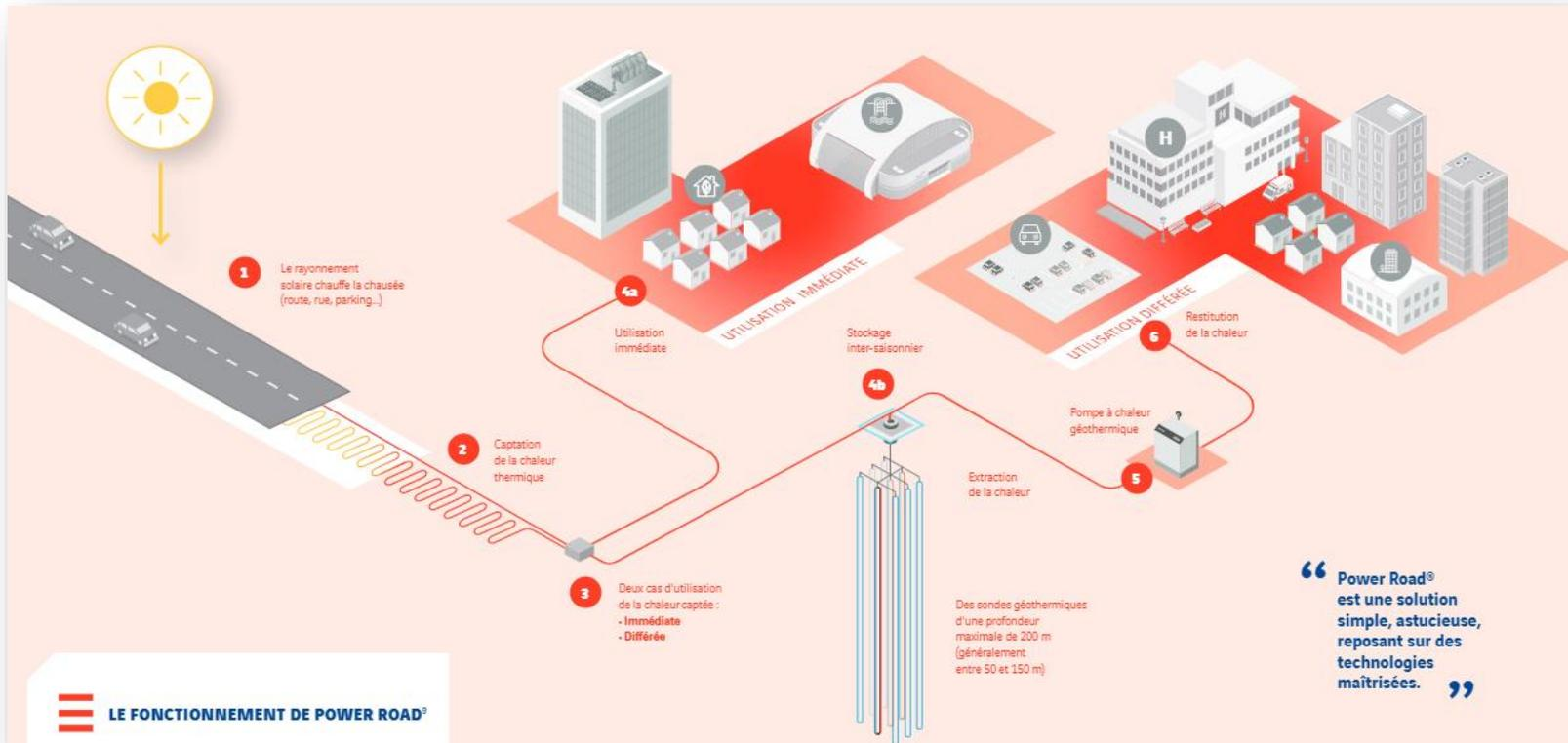
**Power Road c'est : un échangeur thermique, une pompe à chaleur, un stockage géothermique**
