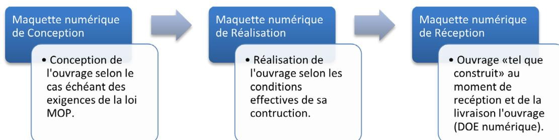
Figure 6 : Evolution de la maquette numérique dans les différentes étapes du projet
