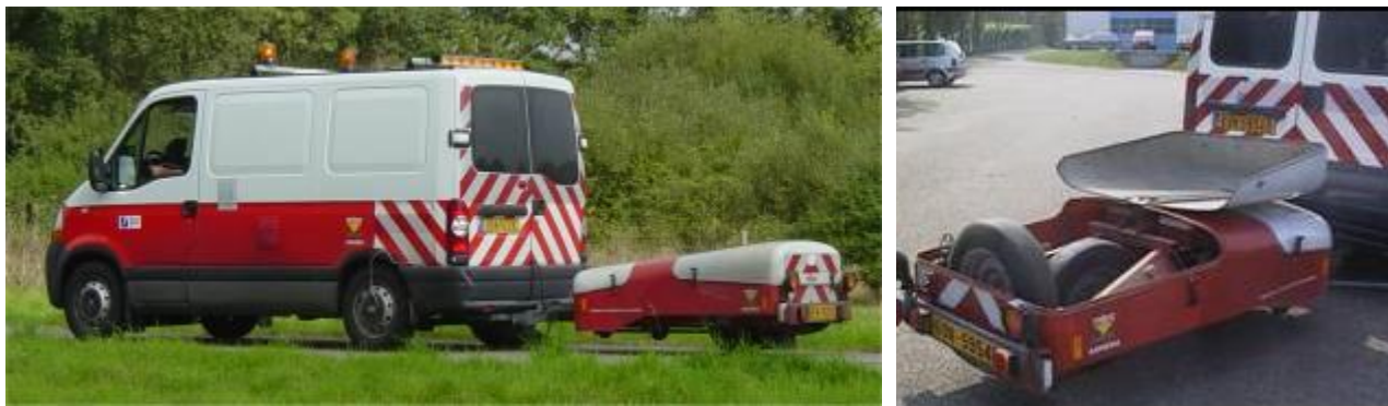
Figure 10 : Appareil de mesure ADHERA
