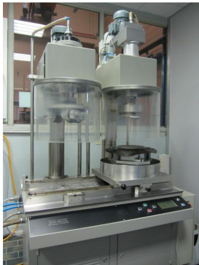
Figure 20 : La machine Wehner et Schulze – vue générale et du disque de mesure avec ses trois patins en caoutchouc
