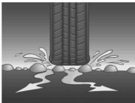
Figure 6 : Schéma descriptif de la macrotexture (CFTR)
