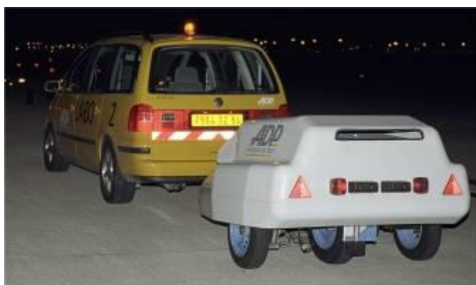
Figure 13 : Appareil de mesure IMAG
