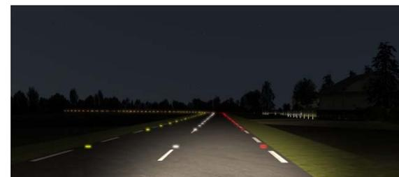
Image issue de la simulation de conduite impliquant les plots lumineux pour alerter les conducteurs en approche de virage
