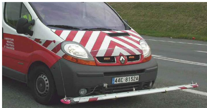
Figure 2 : Transversoprofilomètre à ultrasons (TUS)
