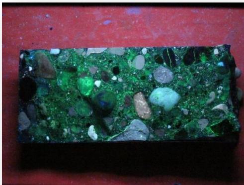
Recherche de gels d'alcali-réaction par fluorescence des ions uranyl Méthode LPC n° 36
