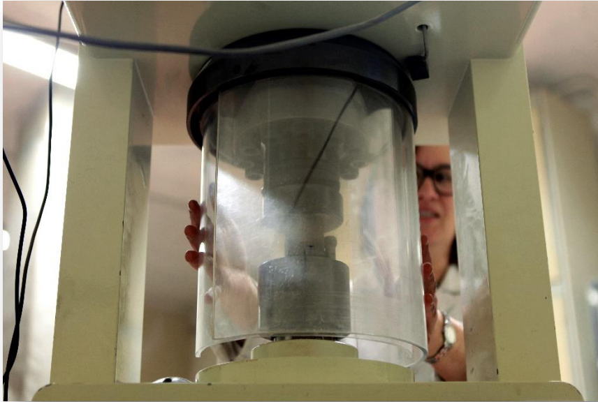
Presse pour essais de résistance ( R_c , R_t )
