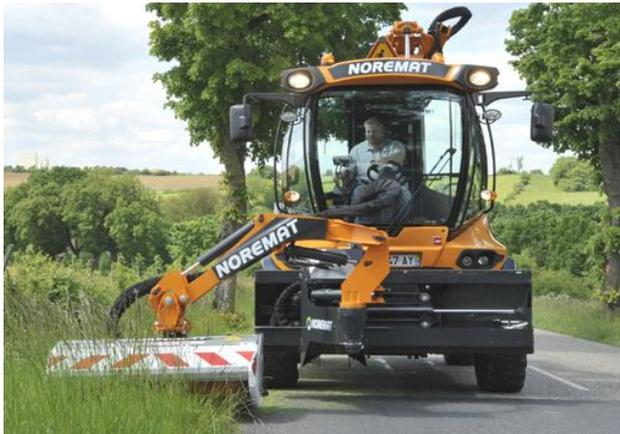
Outil frontal (Lorsque l'architecture du véhicule et le chantier s'y prêtent)
