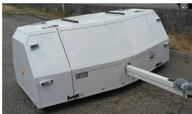
Figure 4 : Remorque de mesure CPX du Cerema (Laboratoire de Strasbourg)
