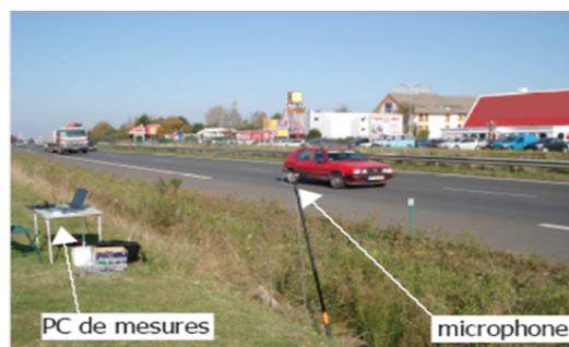
Figure 3 : Mesure de bruit de roulement au passage (VI ou SPB) (source Cerema-lfsttar)
