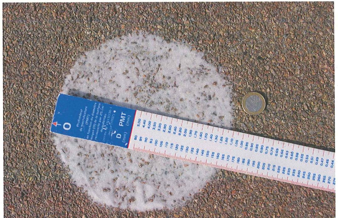
Figure 5 : Mesures PMT de la RD 5 M 2/4
