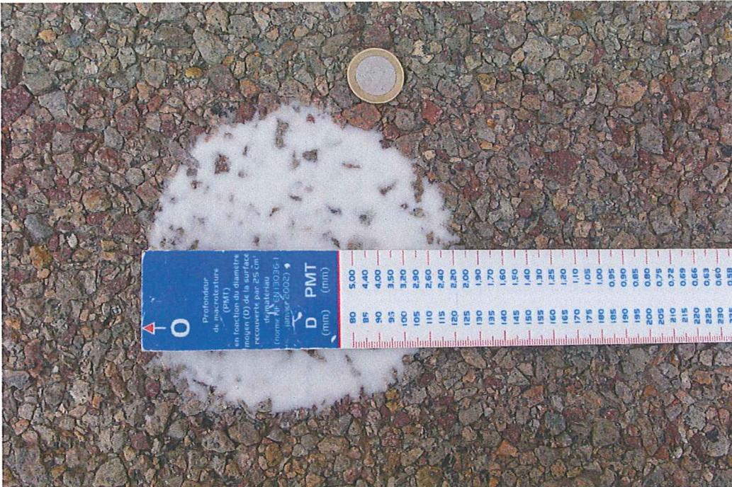
Figure 4 : Mesures PMT de la RD 5 MDG 4/6-2/4
