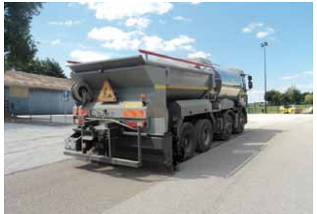
Figure 3. Répandeurs mixtes associant répandage de liant et de gravillons (droits Acmar)
