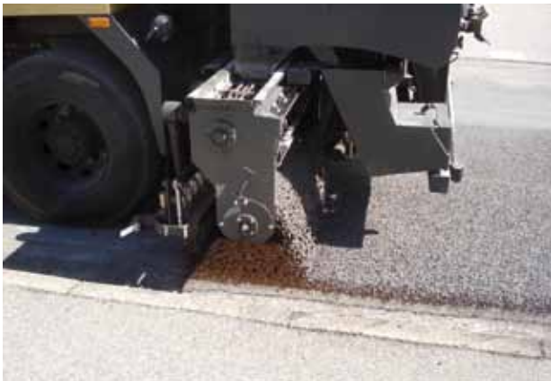
Figure 3. Répandeurs mixtes associant répandage de liant et de gravillons (droits Acmar)
