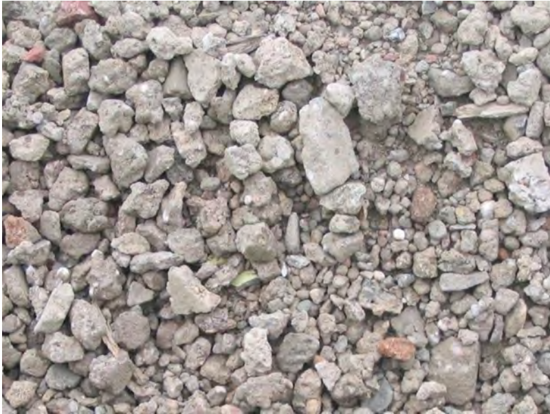
Photo : grave de recyclage 0/20 mm (Source : Colas)
