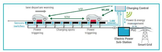
Figure 4. Infrastructures de recharge dynamique des véhicules électriques en mouvement
