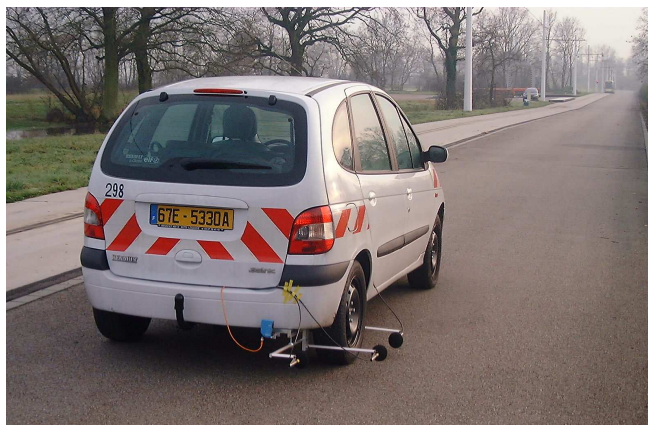
Figure 11 – Mesure du bruit de roulement en continu
