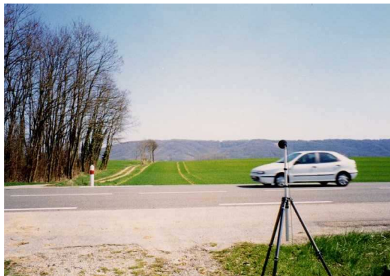
Figure 1 - Mesure bruit de roulement au passage
