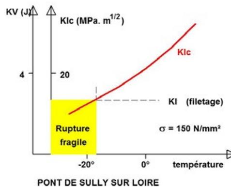
Figure 50 : propagation de la rupture fragile.
