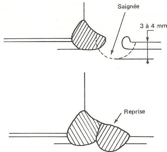
Fig. 119 : Soudure d'angle. Reprise au raccordement (bibliographie [4]).
