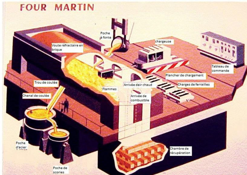
Fig. 10 : Schéma d'un four Martin (document OTUA).
