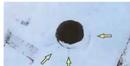
Fig. 63 : Fissuration sur trou de rivet (Photo SNCF).
