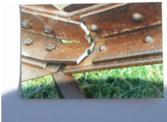
Figure 51 : Rupture plane à fond de filet sur un élément en barre (photo Jean-Paul PERSY).
