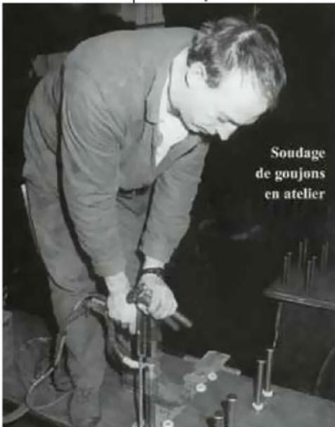
La bague en matériau réfractaire assure une protection par confinement qui limite l'oxydation et maintient le métal fondu. Elle doit être éliminée après le soudage.
