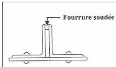
Fig. 98 : Schéma d'une fourrure soudée (bibliographie [15]).
