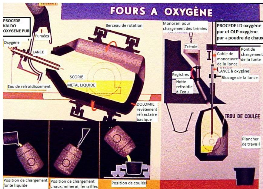
Fig. 14 : Schéma fours à l'oxygène (document OTUA).
