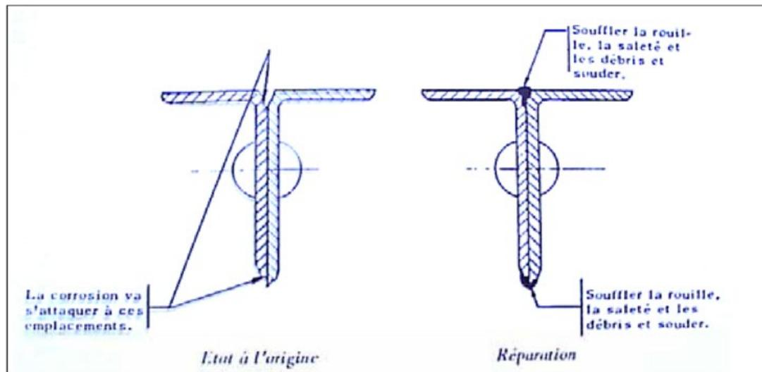
Fig. 97 : Schéma de rechargement par soudure.
