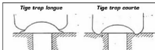
Fig. 62 : Défaut de longueur de tige de rivet.
