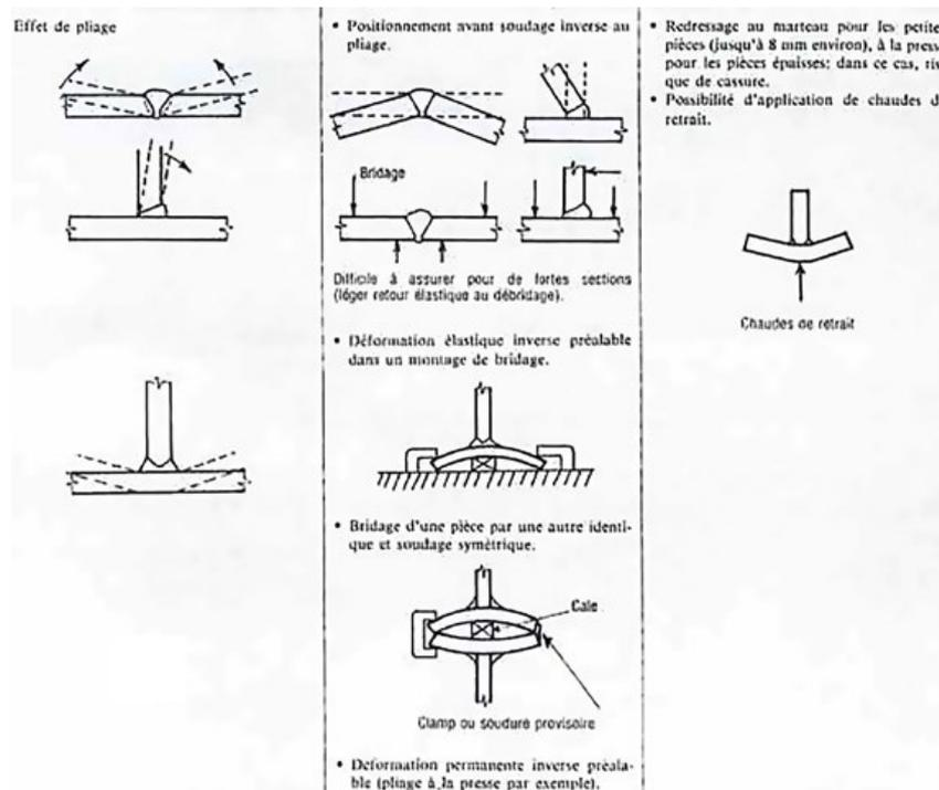
Fig. 110 : Déformations par bridage de soudure (doc. Entreprise Eiffel)
