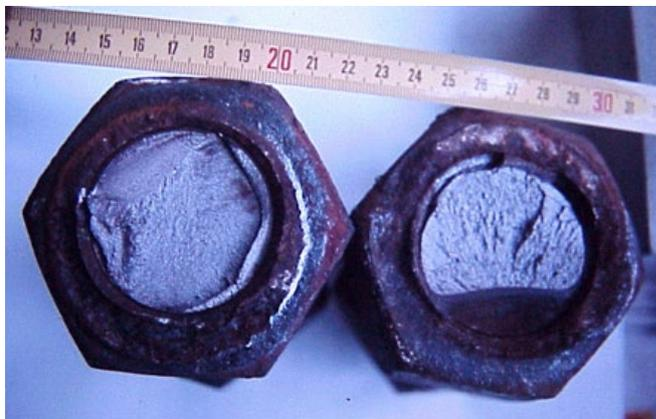
Figure 37 : Corrosion fissurante sur assemblage boulonné de tige d'ancrage (photo Jean-Paul PERSY).
