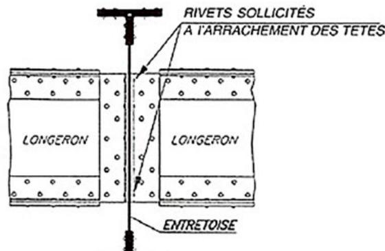
Fig. 148 : Assemblages sollicités parallèlement à l'axe des rivets (bibliographie [15]).
