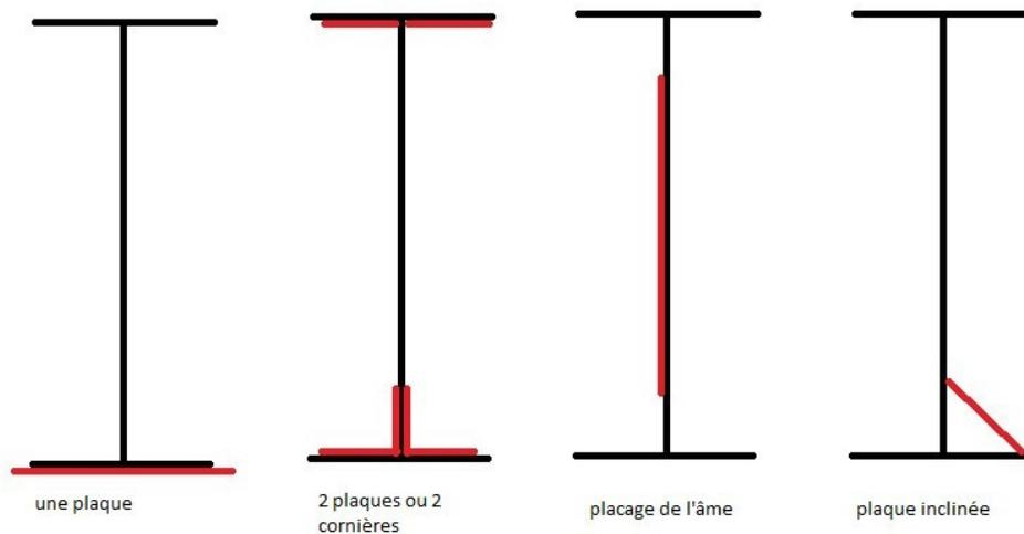
**Fig. 92 : Renforcement par placage d'une poutre en I.**
