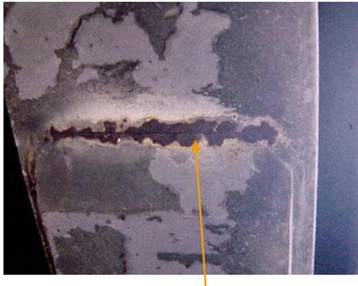
**Figure 59 : Fissure frontale d'une semelle additionnelle de membrure inférieure de poutre (photo Jean-Paul PERSY).**
