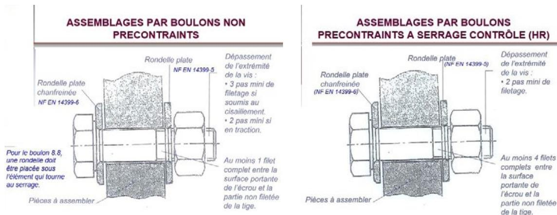
Fig. 132 : Principales conditions de choix dimensionnel des boulons.
