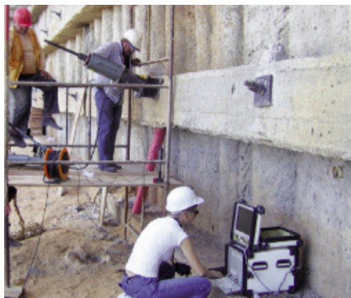
Photo n° 66 : contrôle à l'aide de l'analyse de la réponse vibratoire des tirants d'une paroi (crédit photo A. Bouineau)
