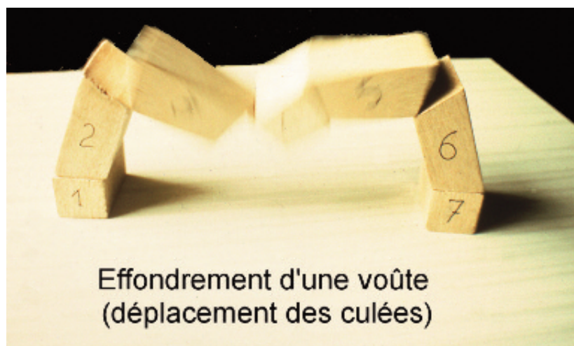
Photo n° 11: rupture d'une maquette (crédit photo D. Poineau)
