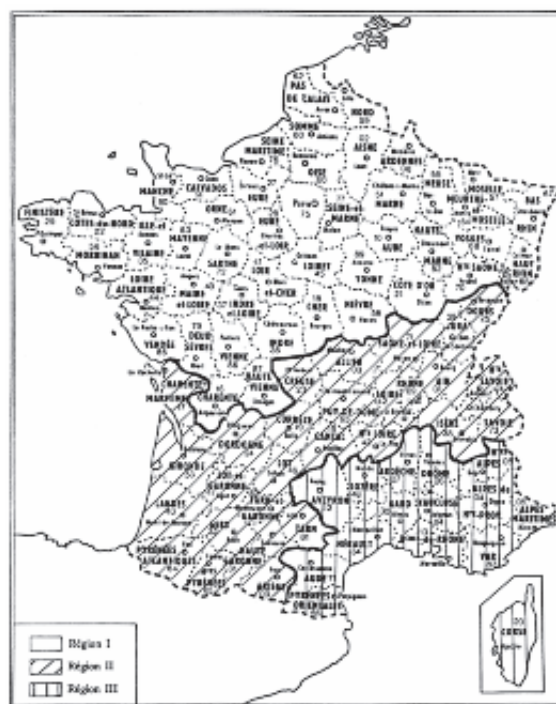
Figure n° 1 : carte des zones de pluviométrie homogènes de l'instruction technique de 1977
