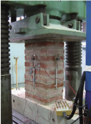
Photo n° 14 : essais d'un muret de briques (extrait de la thèse)
